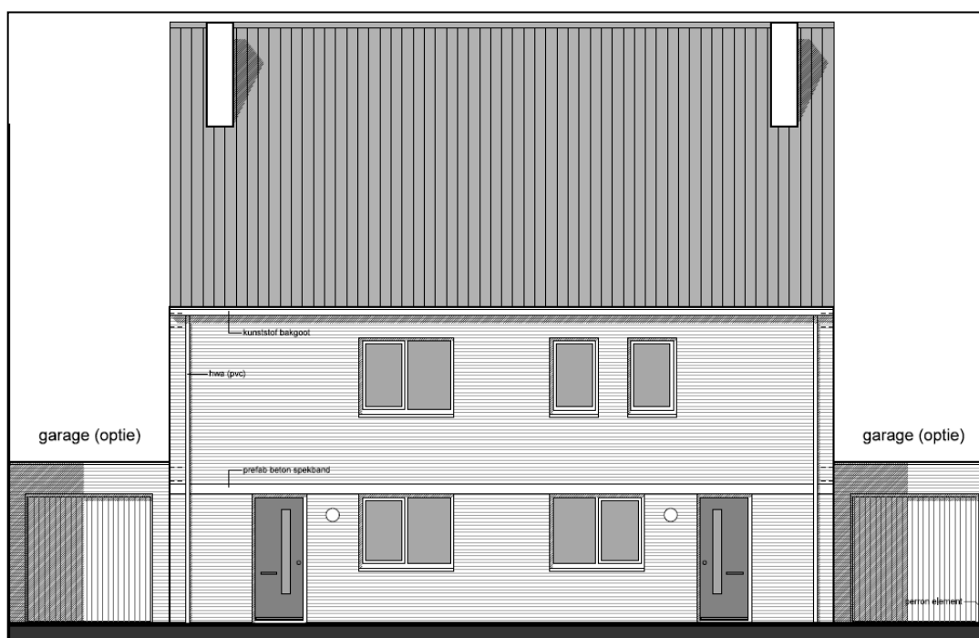
Voorgevels twee-onder-één-kapwoningen (bron: Verheij Architecten)
